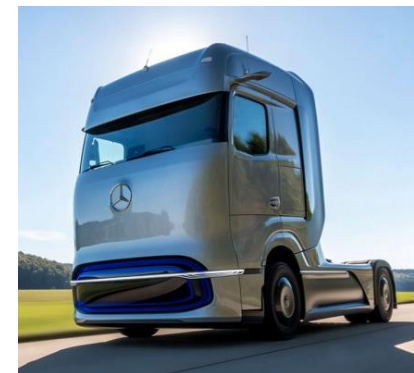
液体水素を用いた コンセプトFCトラック "GenH2" (ボルボトラックとの共同開発)
