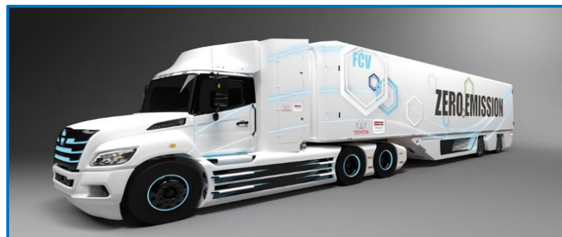
日野の米国市場向け新大型トラックHINO XLシリーズをベースに，“Mirai”のスタックを使って共同開発し，2021年から実証試験を開始。
